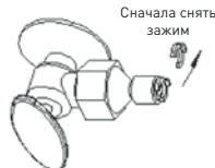
Шаг 2: закрутить головку быстрого разъема концом с резьбой на кран, после чего снять зажим
